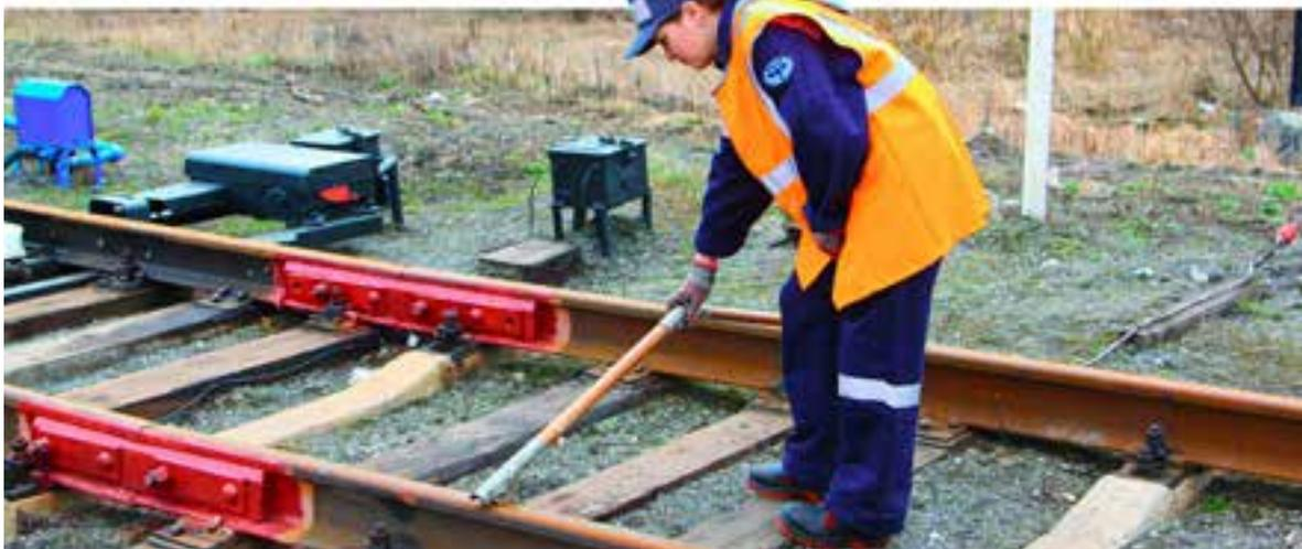
Проверяет рельсовую цепь на шунтовую чувствительность путем наложения нормативного шунта сопротивлением 0,06 Ом.
