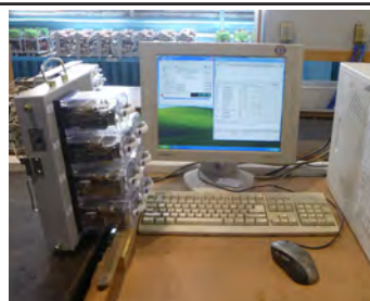
Рабочее место для проверки релейных блоков
